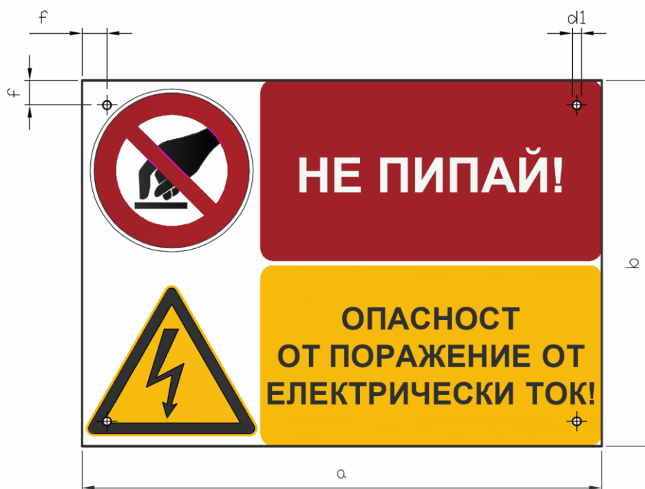
Фиг. 2 Табела „Не пипай! Опасност от поражение от електрически ток!”
